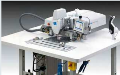
Dürkopp Adler 911-210 – Nähanlage für den Einsatz im Bereich von reproduzierbaren Sicherheits- und Funktionsnähten sowie dekorativen Ziernähten
