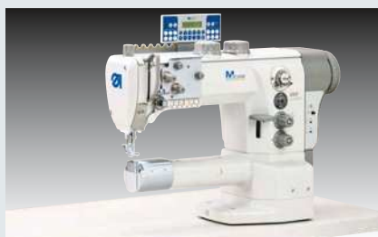
Dürkopp Adler 869 – Freiarmmaschine mit integriertem Direktantrieb und Vertikalgreifer
