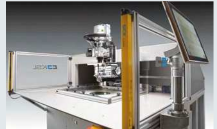
KSL 351 – CNC-Drehkopf-Portalnähanlage für Servo-motorisch gesteuertes, kontinuierliches oder intermittierendes Nähen frei programmierbarer Sicherheits-, Funktions- und dekorativer Nähte
