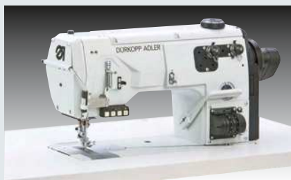
Dürkopp Adler 195 – Ein- oder Zweinadel-Doppelkettenstichmaschine für den Einsatz im mittelschweren Anwendungsbereich
